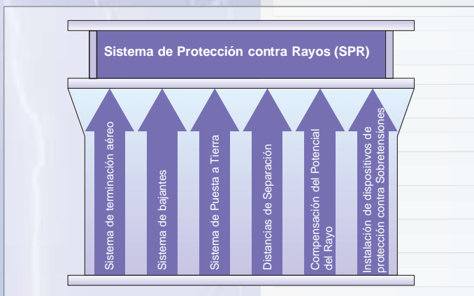
Fig.6 Sistema de Protección contra Rayos
